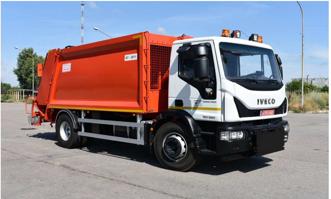
Рис. 37. Сміттевоз СВ303.1 на шасі «Iveco»
