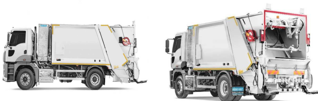
Рис. 17. Сміттевоз Ford Truck з обладнанням для миття контейнерів Hidro Mak
